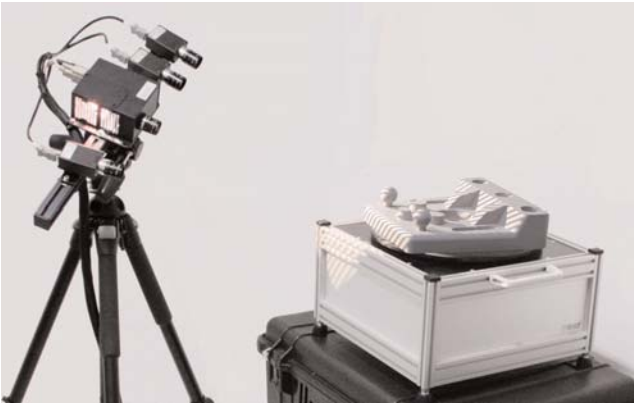
QTSculptor 3D Scanner PT-M1280 und Drehteller PT-R200
